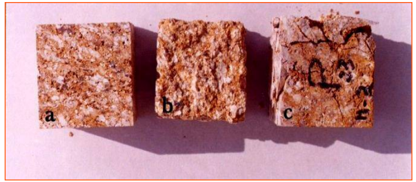
Granito silicificado ocre de Ávila: a) Referencia (cantera), b) 10 ciclos de envejecimiento de cristalización de sales: fuerte deterioro superficial (desagregación) y c) 18 ciclos de envejecimiento combinado de cristalización de sales y hielo/deshielo: fisuración y pérdida de materia.
